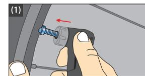
(1) Inserte el cabezal de la mini bomba en la válvula de la llanta.
