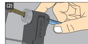
(2) Levante la palanca para sujetar con seguridad la válvula, luego infle.
